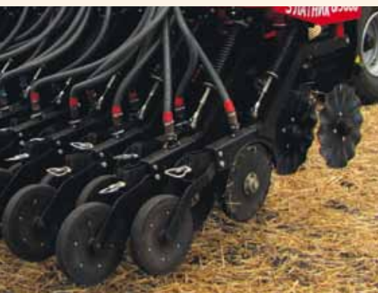
Двухдисковый сошник со смещением и волнистым диском спереди.
