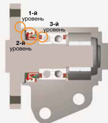
Сверхнадежная трехуровневая защита подшипника
