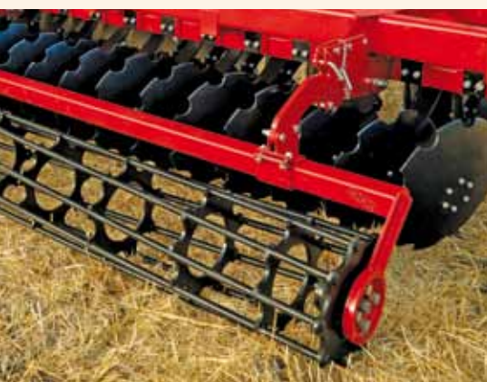
Прутковно-клетевой каток без центральной оси
