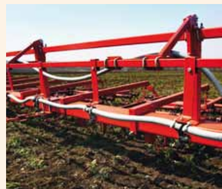
Гибкие трубопроводы и форсунки легко крепятся к любой стандартной бороны
