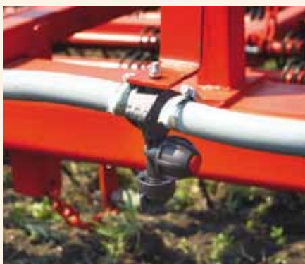
Гибкие трубопроводы и форсунки легко крепятся к любой стандартной бороны
