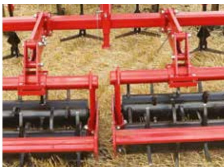
Преимущества шпорового самоочищающегося катка
