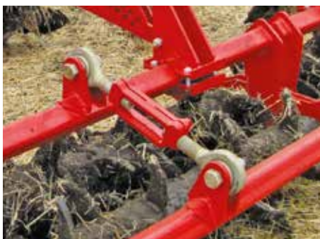
Возможность выбора почво-обработки регулировкой катков
